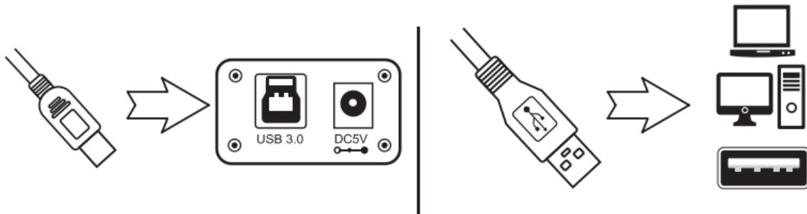
Затем подключите адаптер питания к электрической розетке, без этого подключения USB-Хаб не будет функционировать при подключении к нему устройств большой мощности. Светодиоды указывают, что USB-Хаб получает питание.
