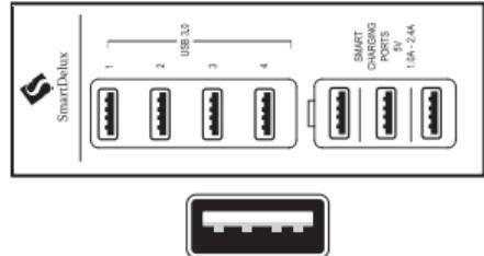
\* USB хаб сумісний з USB 3.0, USB 2.0 і USB 1.1, але швидкість Super Speed (до 5 Гбіт / с) можлива тільки тоді, коли USB-Хаб підключений до USB 3.0 - порту комп'ютера або ноутбука, а периферійні пристрої, підключені до USB 3.0 - порту USB-Хаба.
