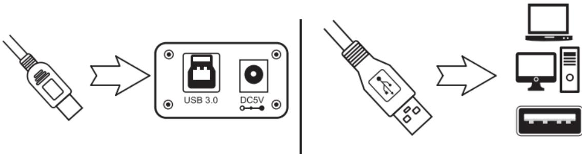
Потім підключіть адаптер живлення до електричної розетки, без цього підключення USB-Хаб не працюватиме при підключенні до нього пристрій в великої потужності. Світлодіоди вказують, що USB-Хаб отримує живлення.
